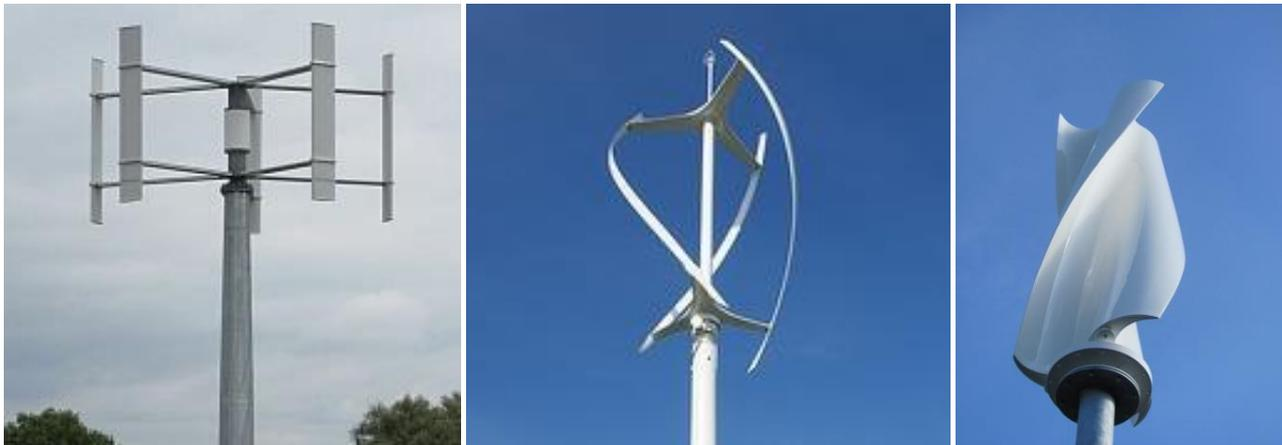
Abb. 74: Beispiele für horizontale Kleinwindkraftanlagen: H-Rotor, Darrieus-Rotor, Savonius-Rotor,<sup>121</sup>
